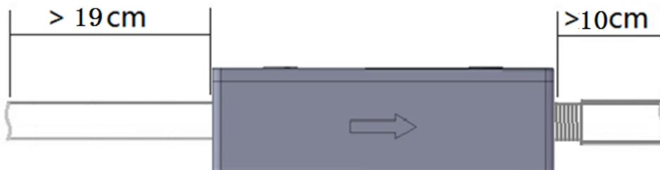
注意安装时气流方向与传感器气流指示方向一致，传感器引出线按照定义对应正确连接后，再接通电源开始工作。
