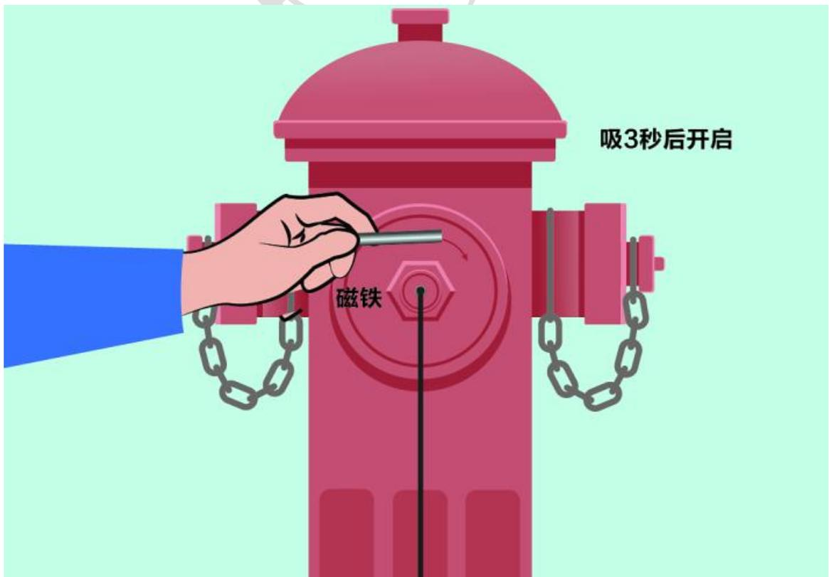
(10) 安装铁链，确保铁链紧固；
