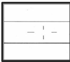
在需要测量应变的位置沿着应变的方向做好记号。使用 4H 以上的硬质铅笔或划线器，注意在使用划线器时，不要留下深的刻痕。
