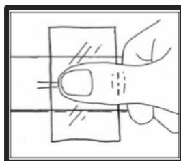
在置于粘贴位置的应变片上面盖上附带的聚乙烯树脂片，并在上面用手指加压。步骤⑤，⑥，⑦要连贯快速地进行。将放好的应变片取下调整位置重新粘贴时会使粘性极大地下降。
