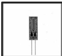
根据被测物与目的选择应变片的种类及长度。应变片的热膨胀系数如 13 页表中所示，可以从中选择适用于被测物的应变片。
