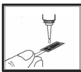
首先要确认好应变片的正反面。向应变片的背面滴一滴粘贴剂 (CC-33A)。如果涂抹粘贴剂的话，先涂抹部分的粘贴剂会出现硬化，使粘性下降。因此不使用涂抹的方式
