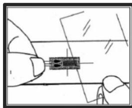
将滴有粘贴剂的应变片立即粘在所作记号的中心位置。
