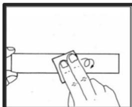
将应变片要粘贴的位置（范围要大于应变片的面积）用砂布 (#200~300) 打磨，直到除去油漆，锈迹及镀金等。
