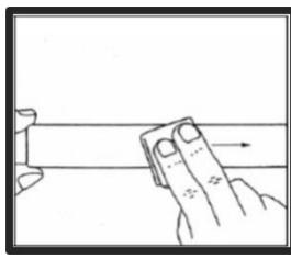
用工业用薄纸蘸丙酮溶液对要粘贴应变片部位进行清洁。在清洁过程中，沿着一个方向用力擦拭，然后再沿着相同方向擦拭。如果来回擦拭会使污物反复附着，无法擦拭干净。
