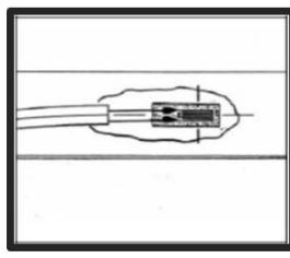
加压一分钟左右，取下聚乙烯树脂片，确认是否已粘贴牢固。这样整个粘贴过程结束。为了达到更好的效果，最好将应变片放置 60 分钟左右等粘贴剂完全硬化后再使用。
