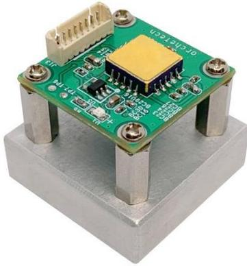
XYJ1600 系列单轴电容式超低噪声 MEMS 加速度传感器，主要应用于地震、振动和惯性等领域。该加速度传感器由全硅 MEMS 敏感结构和低功耗信号处理 ASIC 组成闭环系统，噪声、动态范围、非线性、重复性、温度漂移、抗冲击等性能优越，动态范围可达 120db，是目前行业内最具竞争优势的产品之一。
