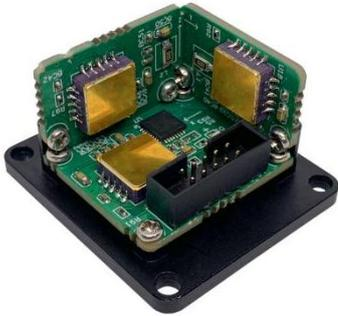
XYM9001 加速度传感器是基于 MEMS(微机电系统)加工工艺的高性能振动监测传感器, 该传感器可采用  $5V\pm 3\%$  电源供电, 集成 X-Y-Z 三轴和自检测 ST 功能, 专门为地震和振动监测应用领域而设计。XYM9001 采用超高性能加速度计, 动态范围可达 120dB。该传感器在出厂时经过严格的筛选测试。在噪声、动态范围、非线性、重复性、温度漂移、抗冲击等性能上具有优越的表现, 是目前行业内具有竞争优势的一款产品。
