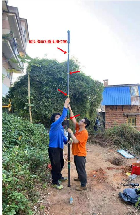
图 14: 安装传感器
