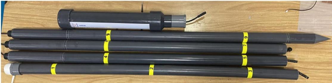
图 1: CISS09-NB 实物图 (4米9节点)
