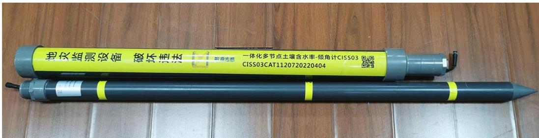
图 3: CISS03-Cat1 实物图 (1米3节点)
