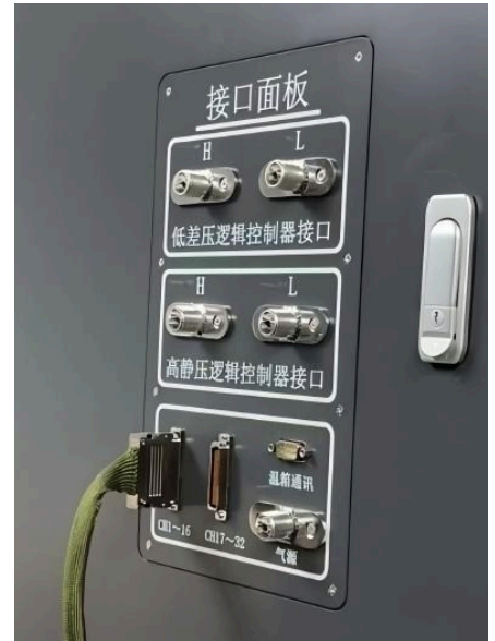
图2 模块化的集成气路和电器接口
