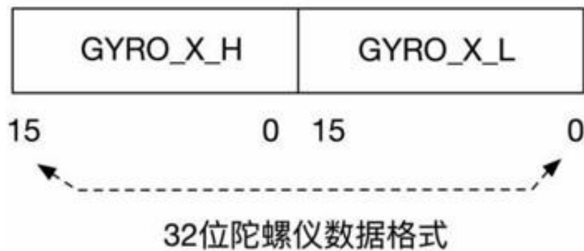
图 20 SPI 32 位数据还原示意图
