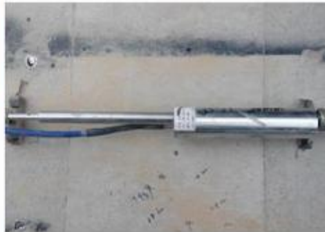
用于监测宽接缝的测缝针
