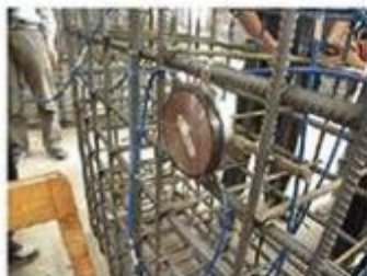
预固定的埋入式应变传感器
