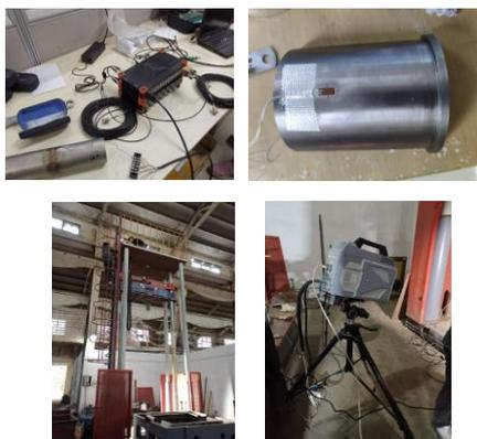
方案功能：主要针对有高速爆炸冲击环境下应变测试需求客户。本方案从动态数据仪器-特种应变片-传感器-特殊粘贴工具-服务培训一站式，可以让客户在高速动态环境下进行应变测试。
