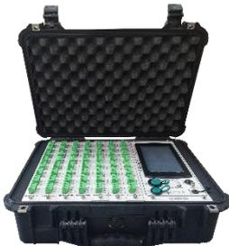
自带集成 PC 和触摸屏，无需电脑，可独立长时间工作。同时也兼具连接电脑测试功能。一体防护箱设计，携带方便，非常适合现场测试。
