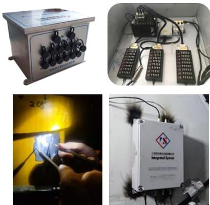
方案功能：主要针对结构建筑等长期安全环境下应变测试需求客户，本方案从仪器-各种应变片-传感器-特殊工具-现场培训一站式，可以让客户在设备长期运行中进行应变测试。
