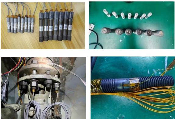
方案功能：在客户提供的螺栓上安装、粘贴用于测量轴力的应变片的一站式，利用公司长年积累起来的特有经验，提供因蠕变或温度变化而产生输出波动很少的轴力计。
