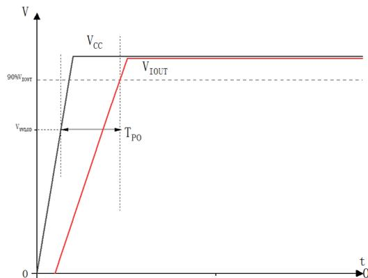
图 7. 启动时间  $T_{PO}$
